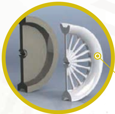
Moderne Motorreinigung: Die 3D-gedruckte Düse reinigt nach der spanenden Bearbeitung Sacklöcher in Motorblöcken.
